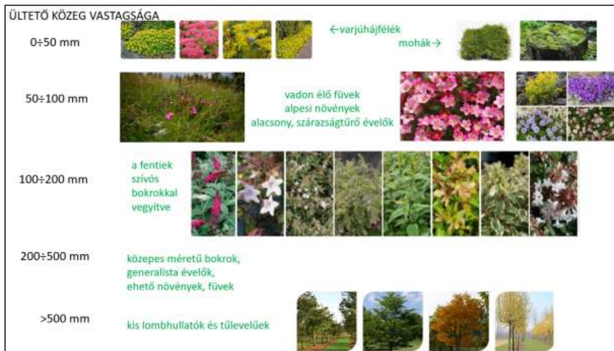
23.ábra zöldtetőre javasolt növények az ültetőközeg szükséges vastagságával
