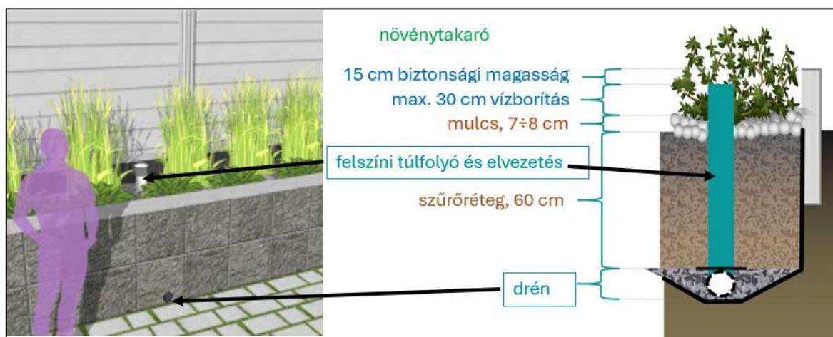
10. ábra: növényes vályú és vízáteresztő burkolat kombinációja
