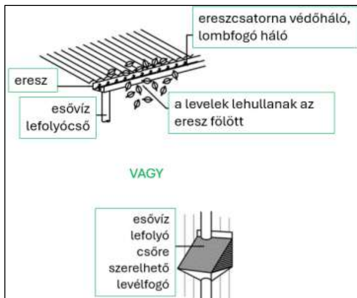
29.ábra a tető és a tároló között elhelyezett levélfogó (durva szűrők)
