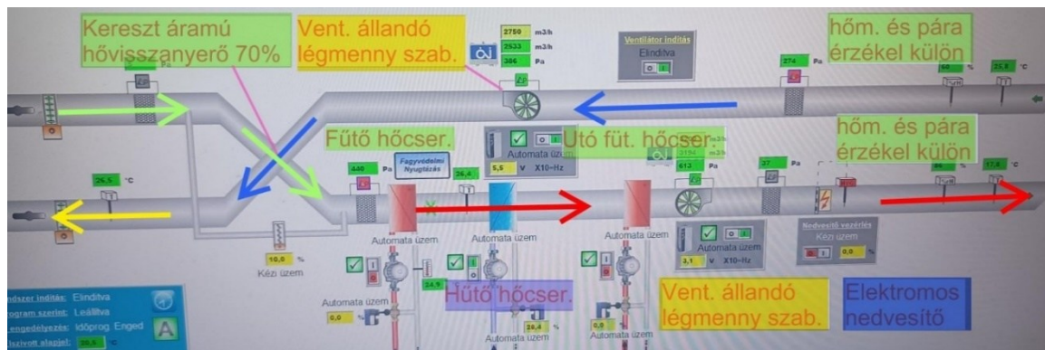
57. ábra Műtő klímagép keresztáramú hővisszanyerővel elektromos gőznedvesítővel
