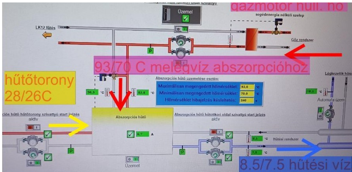
55. ábra Abszorpciós hűtőgép épületfelügyeleten
