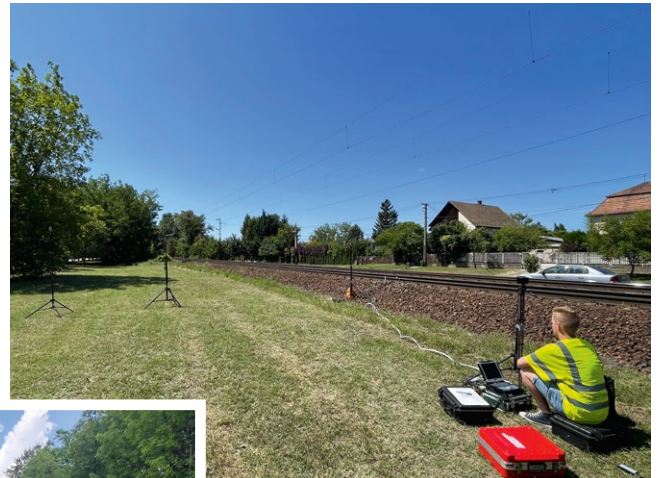
Szimultán zaj-rezgés mérés sebességméréssel, zajmérés a sínszállhoz közel, illetve 7,5 m távolságban, elhaladás-mérés normál üzemi állapotban
