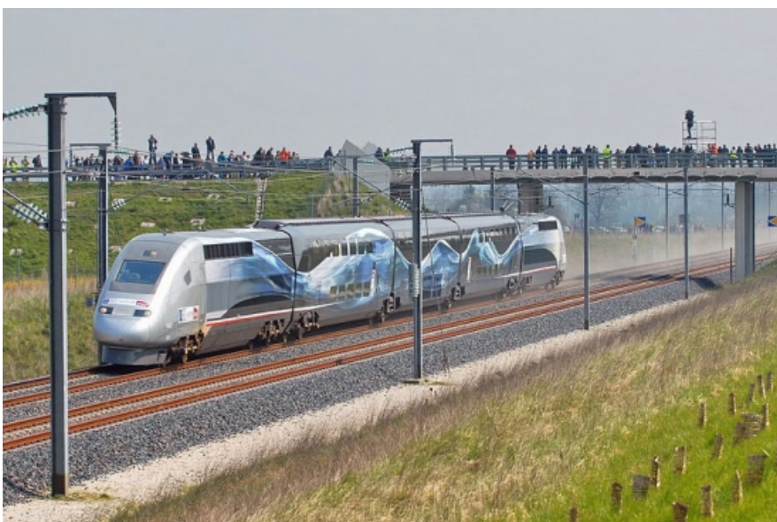
5. ábra: A hagyományos vasúti vontatás abszolút sebességrekordere, az Alstom TGV POS V150 emeletes szerelvénye. A vasútvonalon, ahol végül elérte az 575
