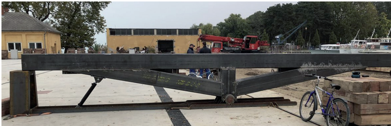
Az első hajóbillentő a munkahengerrel és a végtámasztó bakkal
