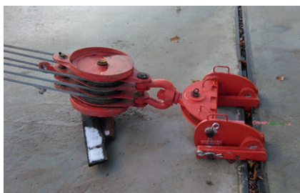
A csiga, a csigarögztítő és a sín már alkalmazásban, terhelés alatt
