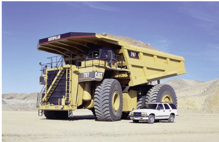
400 tonna teherbírású Caterpillar 797 ércszállító dömpert nyílt színi bányászathoz
