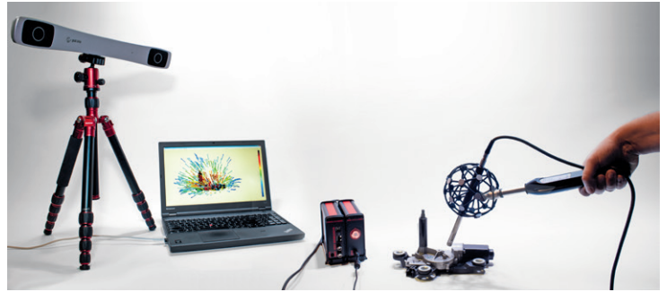
10. ábra: 3D hanglokalizáló rendszer (Forrás: Microflown Technologies)
