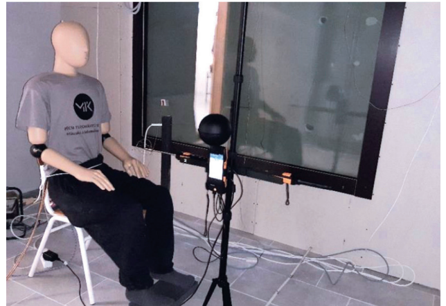
4. ábra. A termikus műember és a TESTO 400 műszer elhelyezése a fűtő üvegfelület előtt 4
