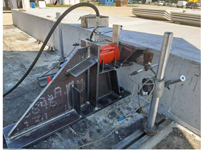
7. ábra: Hídszegély-teherbírási mérése
